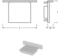
Caractéristiques Ledvance Rubans LED Embout pour Profil PW02
